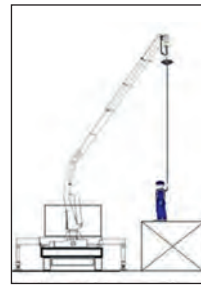
Abb. 5: Günstige hohe Befestigung des HSG (geringe Pendelsturzgefahr)
