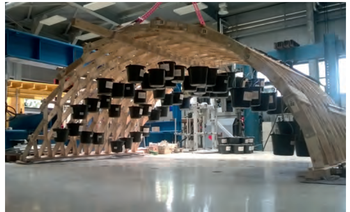
Abb. 5: Simulation einer gleichmäßig verteilten Flächenlast mittels Sandeimern ( F = 0,2 \text{ kN} ) am Großmodell in der Versuchshalle der HTWK Leipzig
